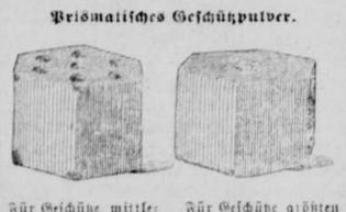
Für Geschüße mittleren und größeren Kalibers (7 Kanäle).
