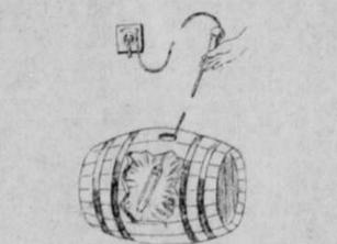
durch die kleine Oeffnung des zu untersuchenden Hohlgefäßes geleitet wird, wodurch dem Beobachter ermöglicht wird, eine sorgfältige Untersuchung vorzunehmen. Da das kleine Glühlicht kein Entzündungsexplosionsgas oder Flüssigkeiten verursachen kann, so wird das neue Instrument mit voller Sicherheit durch das Spundloch von Flüssigkeiten gefüllt werden können, die mit derartigen gefährlichen Substanzen gefüllt sind.
