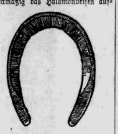
An der Bodenfläche abgedachtes Eisen.
