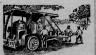
gestellt, und sie sind durch einen metallischen Baldachin ziemlich gut geschützt. Wenn die Küche im Betriebe ist, sind gewisse Teile, die sonst nach innen zusammengeklappt waren, herausgeschlagen, wie das beigegebene Bild zeigt.
