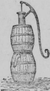
über die zu schützende Pumpe, bis zu genügender Höhe, und füllt den Hohlraum mit Sägespänen, Torfmul, Kaff oder irgend einem schlechten Wärmeleiter aus. In einem der Fässer, nämlich dem, welches gerade in die Höhe des Aushubrohrs kommt, bringt man einen Ausschütt an, durch den, wie die Abbildung zeigt, das Aushubrohr heraustraten kann. Das um dasselbe entstandene Loch dichtet man durch Stroh, Pappe oder dergleichen.
