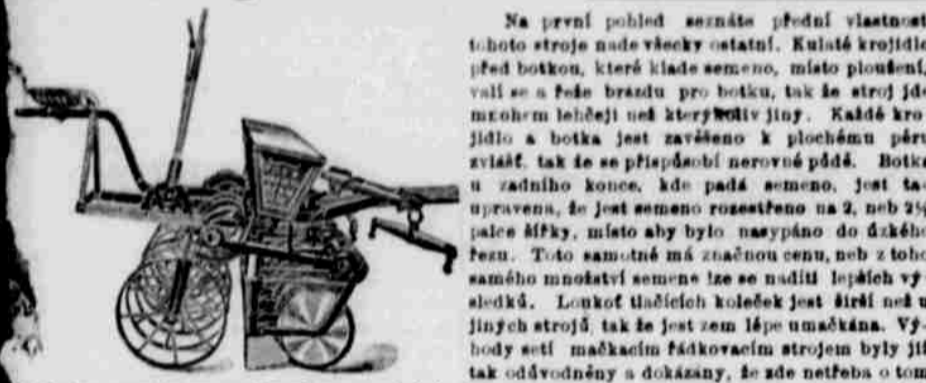
Na první pohled poznáte přední vlastnost tohoto stroje nade všechny ostatní. Kulatá krotidla před botkou, které klade semeno, místo ploužení, valí se a řídí bránu pro botku, tak že stroj jde mnohem lehčeji než kterýkoliv jiný. Každá krotidla a botka jest zavážena k plochému páru zvlášť, tak že se připevní nerovně pód. Botka u zadního konce, kde padá semeno, jest tak upravena, že jest semeno rozestřeno na 2, neb 2½ palce šířky, místo aby bylo nasypano do širokého řezu. Toto samotné má značnou cenu, neb z toho samotného množství semene lze se udělat lepší výsledek. Louček tlačících koleček jest širší než u jiných strojů, tak že jest zem lépe umáčkána. Vyhodily seť máčkacím řádkovacím strojem byly již tak odděleny a dokázány, že zde netřeba o tom
